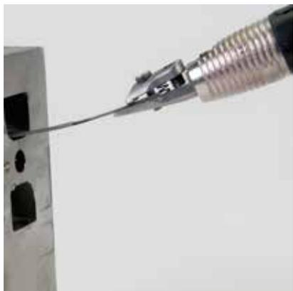
Le lime diamantate a legante galvanico sono particolarmente maneggevoli e necessitano di una forza di pressione particolarmente bassa. Un'elevata pressione causa un consumo rapido, senza portare a un'elevata asportazione di materiale. Negli ultimi anni le lime «Tip» sono avanzate fra i primi nella classifica dei prodotti più gettonati per la risoluzione di problemi.
