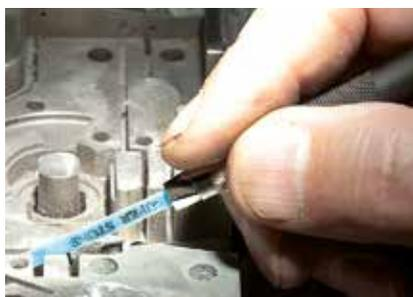
Un eccezionale sostegno nuovo per pietre in fibra 0,5 x 4 mm, in materiale plastico molto resistente, con zona d'impugnatura zigrinata. La pietra in fibra viene inserita fino in fondo, di ca. 12 mm, e bloccata saldamente.
