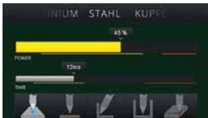
Il moderno schermo touch-screen permette di selezionare il materiale - acciaio, alluminio o rame - e il lavoro da svolgere: superficie, spigolo, gola, scanalatura o angolo, e via.
