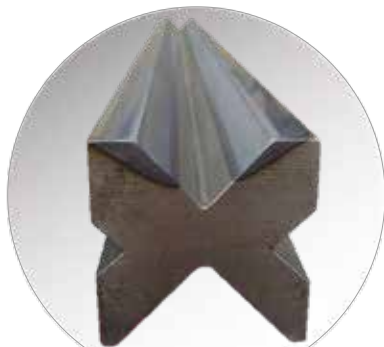
Tempra di una guida di piega in C45, 1.1730. Durezza ottenuta sugli spigoli : 59 HRC
