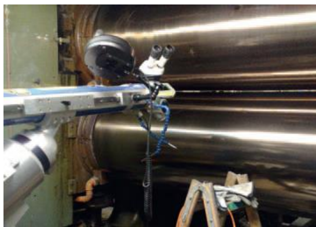
Saldatura di riparazione su rulli (Foto: tcms, Gummersbach)
